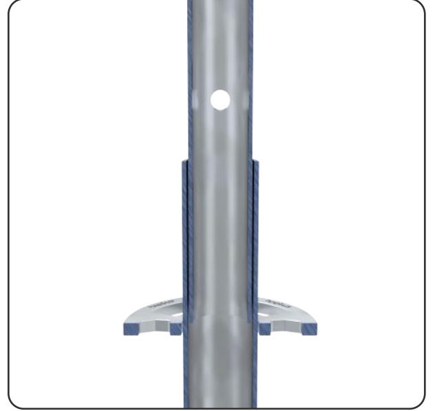
Resim 2.3 Dikme Elemanı Boykesit Detayı
